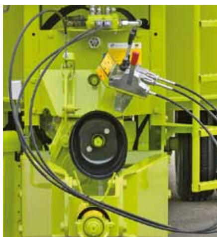
Cambio a due velocità di rotazione coclea, anche con leva in cabina trattore
