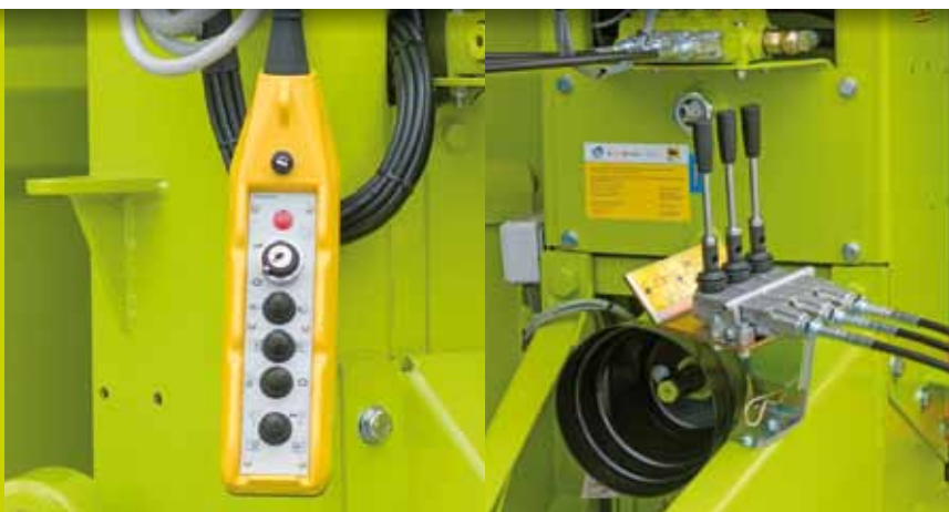
Due tipologie di comandi: elettrici (a sinistra) e me- cchanici flessibili al trattore (a destra)
